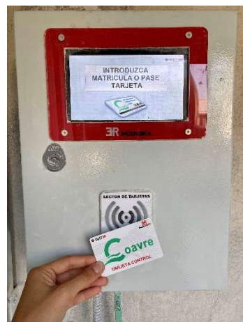
Ilustración 1. Tecnología RFID. Tarjeta y lector.
