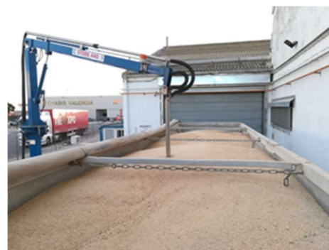
Ilustración 2. Toma de muestra con sonda neumática.
