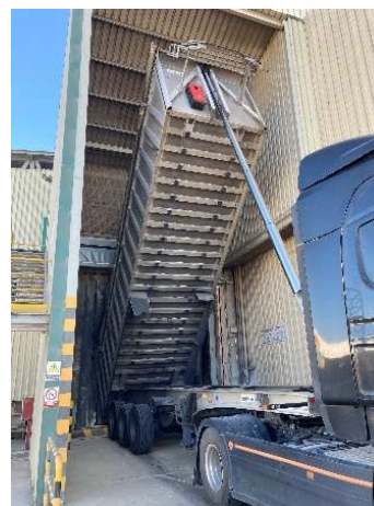
Ilustración 2. Descarga en tolva piquera.
