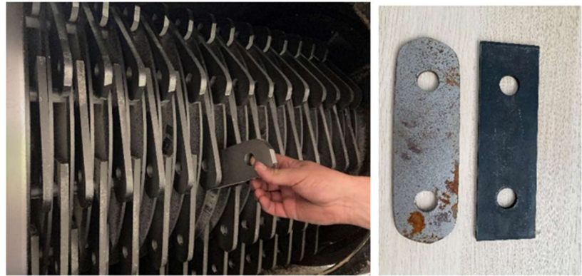
Ilustración 9. Martillos. Comparación martillo desgastado / nuevo.
